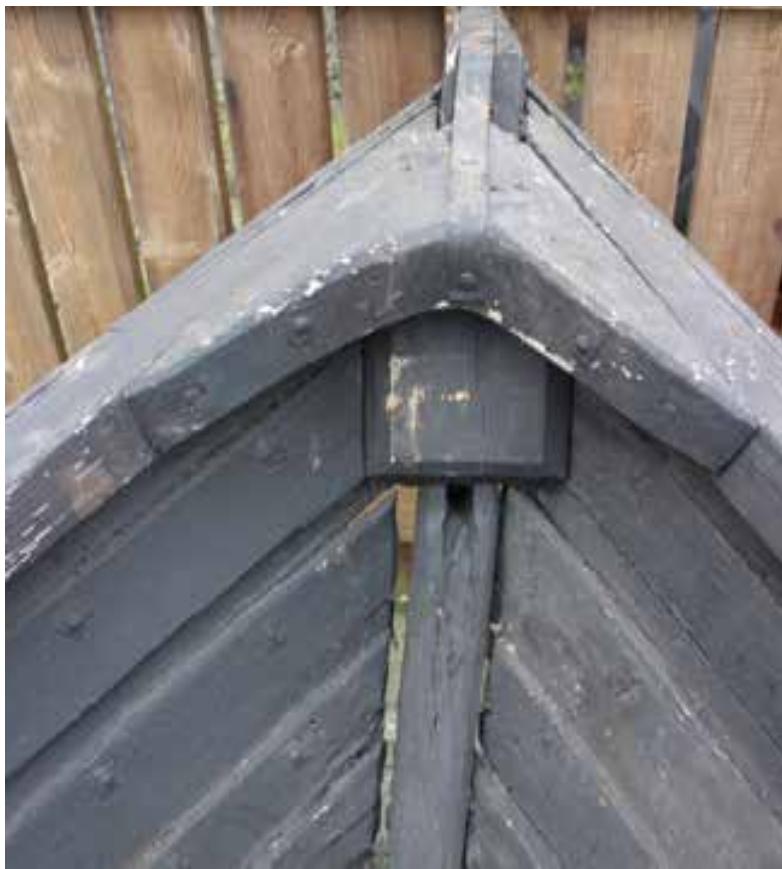
Stefni Farsæls, utan frá og innan. Á neðri myndinni má sjá að byrðingurinn er að losna frá stefninu. Ljósmynd. HMS 2018
