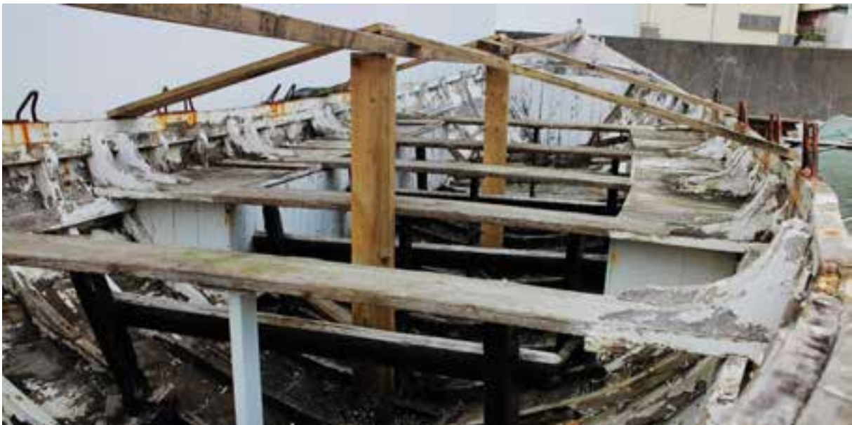
Horft ofan í Eiðisbátinn. Málning er mikið flögnuð og báturinn fúinn en heillegur. Ljós.: HMS 2018
